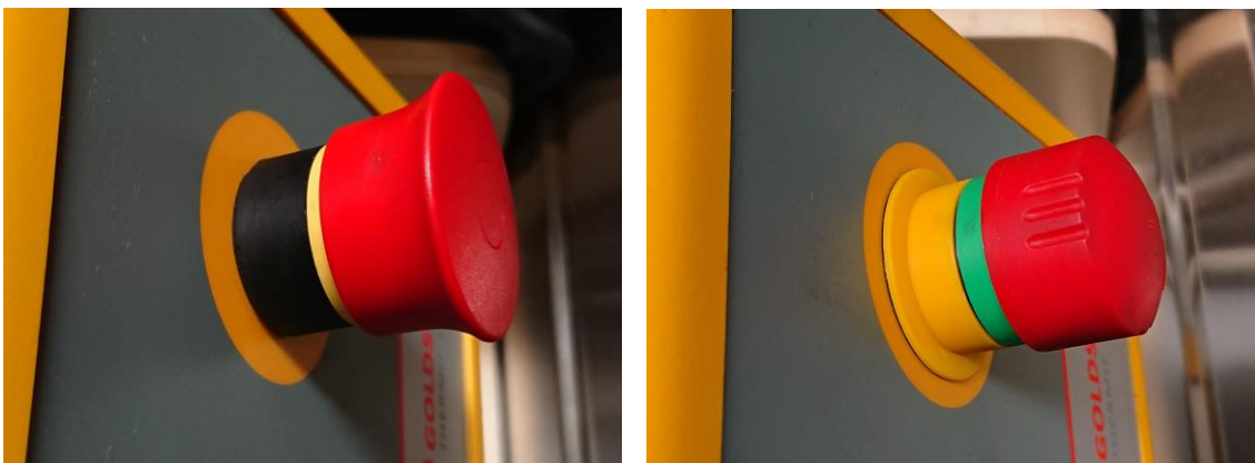
3 paveikslas: Avarinio išjungimo mygtukas paveikslas dešinėje: avarinio išjungimo mygtukas, 230 V modelis; paveikslas kairėje: avarinio išjungimo mygtukas, 110 V modelis
