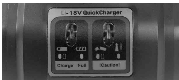
Abb. 7: Kontrollanzeige des Ladegeräts
