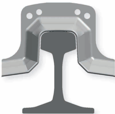
Scherschuh Form A Vignolschiene Shear blade form A Flat bottom rail Seřezávací nůž typu A Širokopatní kolejnice
