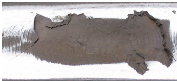
Squat, ein typischer Schienenfehler für die Anwendung des THR-Verfahrens
