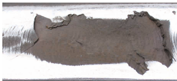
Squat, ein typischer Schienenfehler für die Anwendung des THR-Verfahrens
