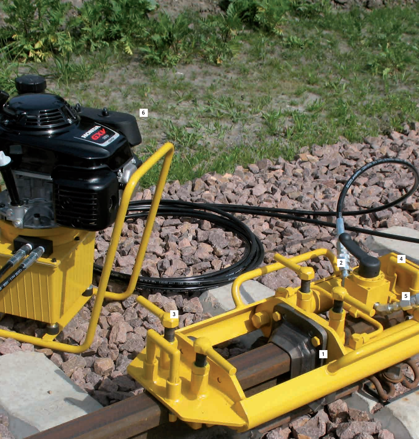
Abschereinheit Typ U-L4 mit Schnelltrennkupplung und separatem Antrieb (Honda)
