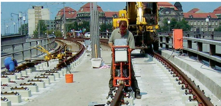
Abb. 4: a) Durchführung der *RailsScan*-Messung;
