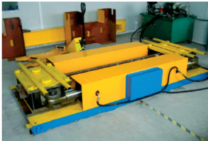
Abb. 3: Unterschiedliche Ausführungen von Kalibrierprüfständen; a) Mobiles Schienenziehergerät zur Aufbringung von Zug- und Druckspannungen; b) Fest installierter Laborprüfstand mit Fundament
