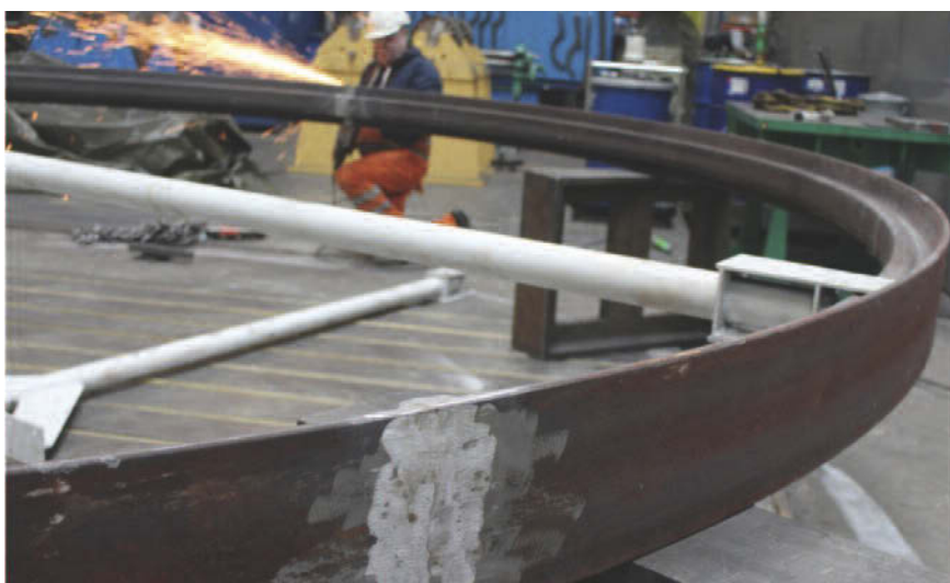
▲ Bild 3. Vorwärmung des zweiten Stoßes bei der Ringschweißung
