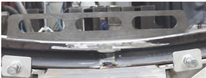
▲ Bild 8. Lehre zum Ausrichten und Schleifen des Rings (Bilder: Goldschmidt)
