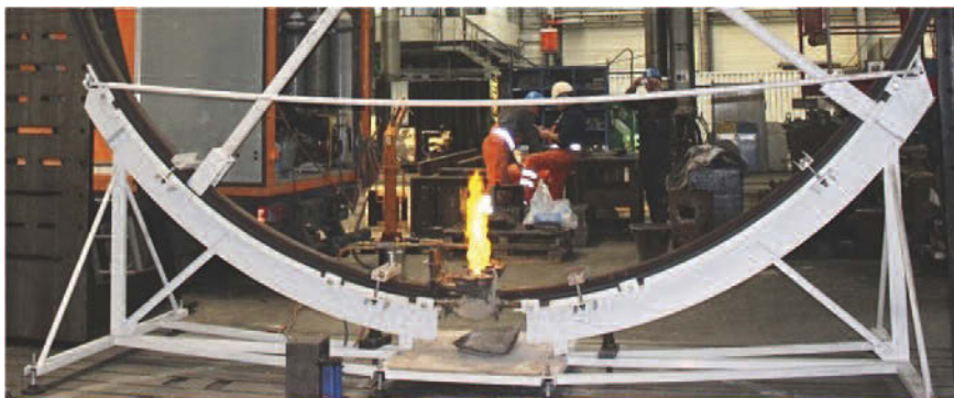
▲ Bild 3. Vorwärmung des zweiten Stoßes bei der Ringschweißung
