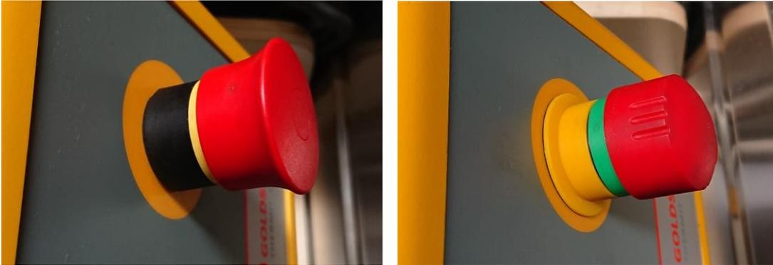
图3：左图：急停开关，230 V 规格；右图：急停开关，110 V 规格
