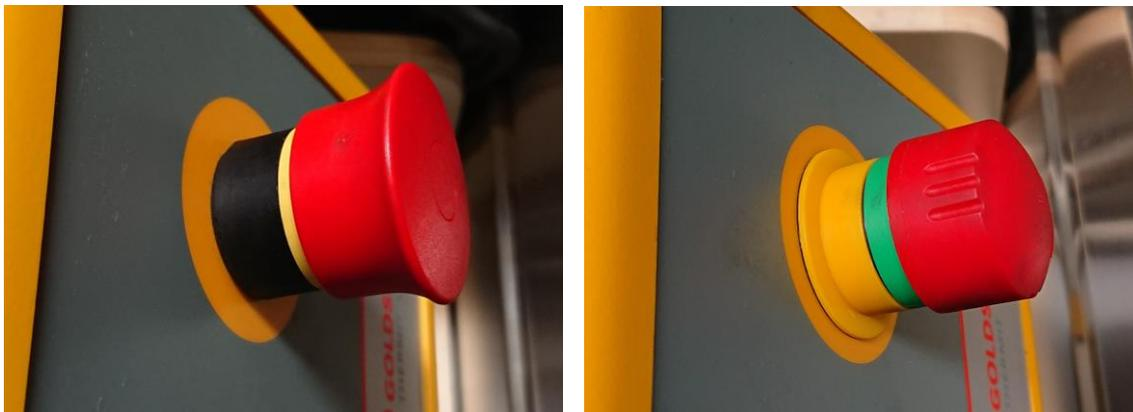
Figura 3: figura a la izquierda: interruptor de parada de emergencia, modelo de 230 V, figura a la derecha: interruptor de parada de emergencia, modelo de 110 V
