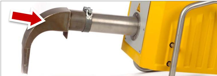
Figura 20: Conexión de la boquilla
