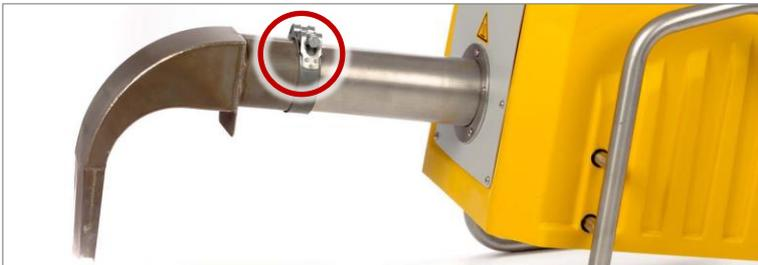
Figura 11: Fijación de la boquilla
