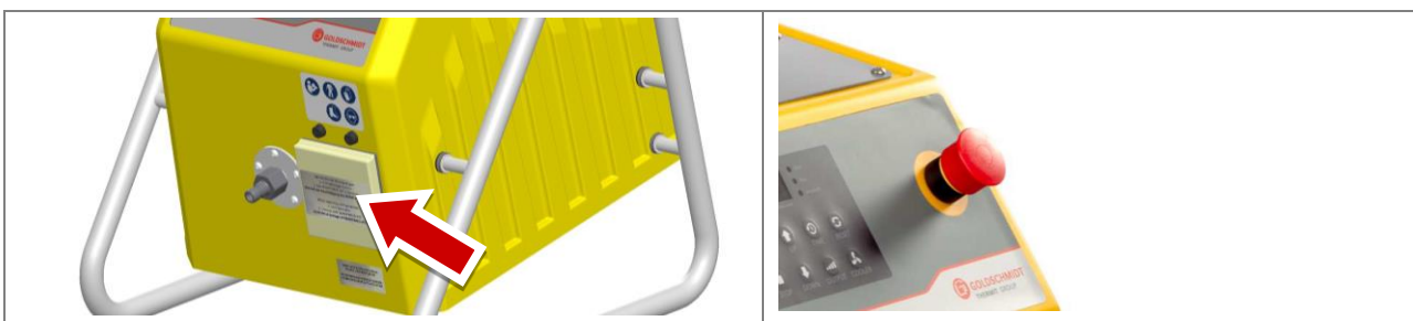
Figura 12: imagem à esquerda: conectar cabos de energia; imagem à direita: interruptor de emergência desativado, 230 V
