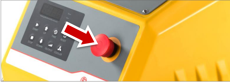
Figura 16: interruptor de emergência
