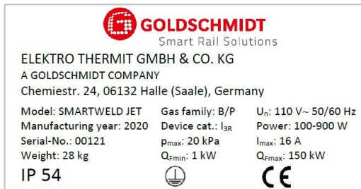
Figura 1b: exemplo de placa de identificação Smartweld Jet, 110 V
