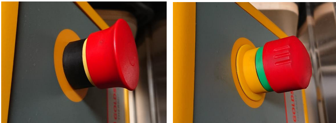
Figura 3: imagem à esquerda: interruptor de emergência, versão 230 V, imagem à direita, interruptor de emergência, versão 110 V
