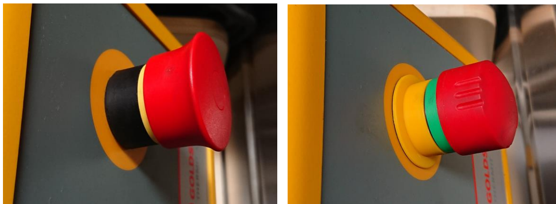
Figura 3: imagine din stânga: comutator de oprire de urgență, varianta 230 V; imagine din dreapta: comutator de oprire de urgență, varianta 110 V
