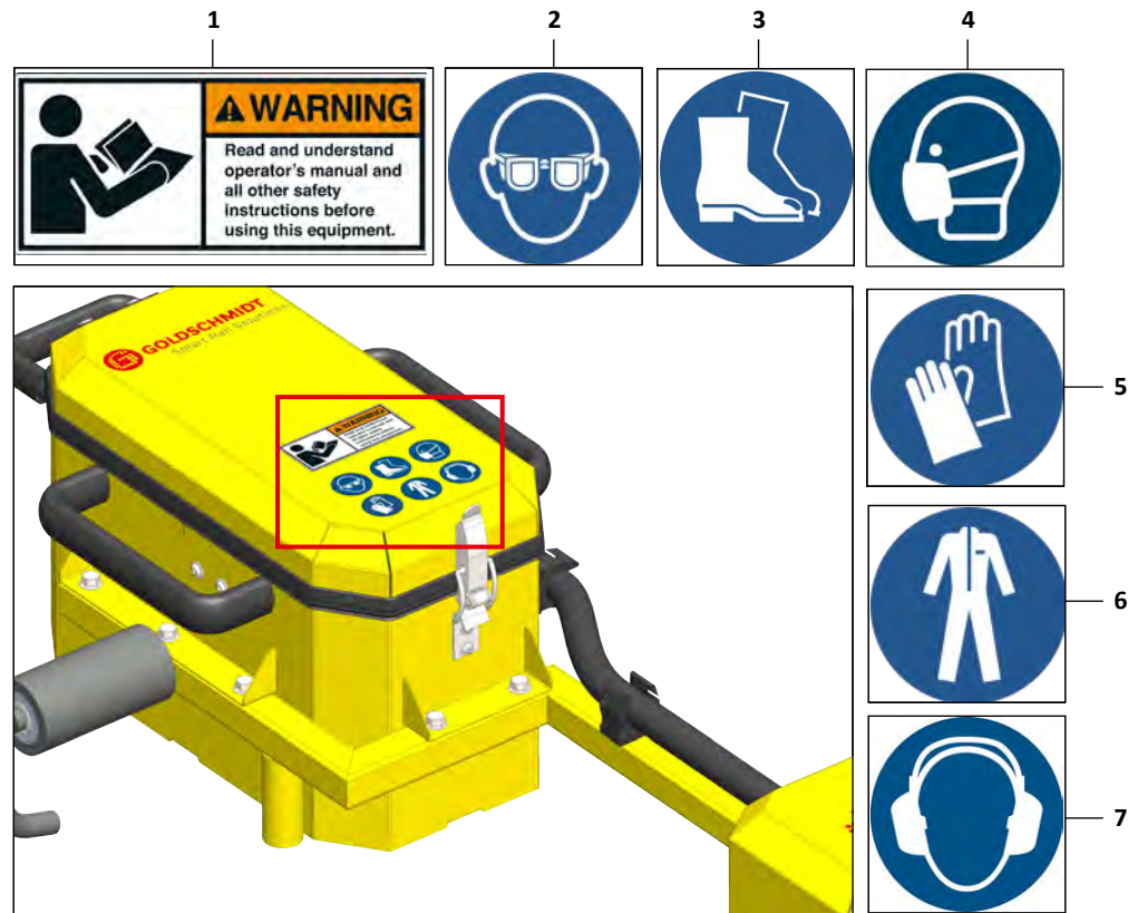
Fig. 2-8 Identificación de seguridad (compartimento de baterías)
