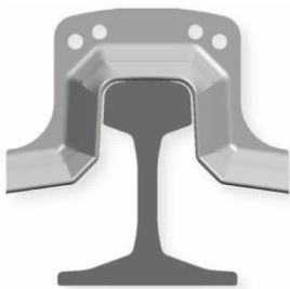
Cuchilla tipo A para carril tipo Vignole
