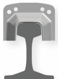
Cuchilla tipo B para carril tipo Vignole y grúa
