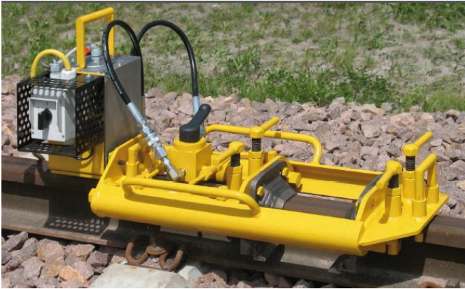
Dispositivo de corte, formado por un equipo de cizallamiento de la serie U-L 4 y una unidad de accionamiento tipo L
