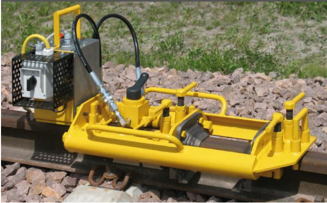
Obcinarka, składająca się z jednostki obcinającej U-L 4 i agregatu napędowego typu L
