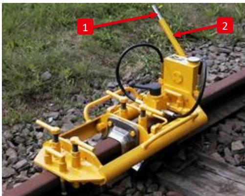
Чтобы выполнить обрезку, необходимо вставить удлинитель (1) на несъемной ручной рычаг (2) и начать быстро качать его. В зависимости от способа сварки для этого требуется 25–30 двойных ходов. После этого рекомендуется быстро отвести обрезные башмаки, чтобы сберечь режущие кромки.
