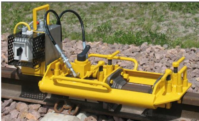
Обрезной станок, состоящий из обрезного устройства U-L 4 и приводного агрегата в исполнении L
