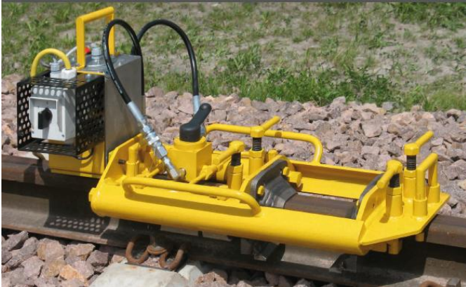
Abschereinheit, bestehend aus Abschergerät U-L 4 und Antriebsaggregat Bauart L
