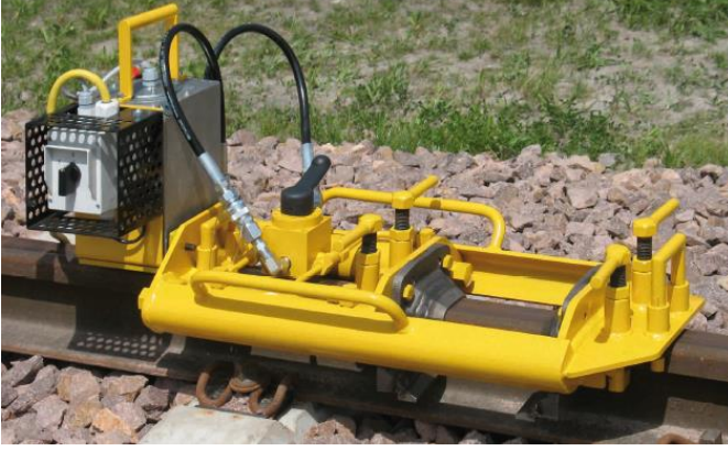
U-L 4 sıyırma cihazından ve L yapı tarzı tahrik ünitesinden oluşan sıyırma ünitesi
