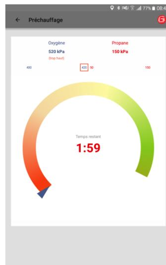
Le diagramme montre les temps de préchauffage restants. Lors du préchauffage, l'application SMARTWELD enregistre la pression des deux gaz toutes les secondes. Si la pression d'écoulement d'un gaz pendant le préchauffage change considérablement, l'utilisateur est averti par une vibration du smartphone / de la tablette et des marques rouges sur la valeur limite correspondante.
