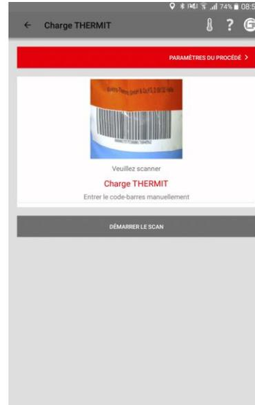
4. Appuyez sur **DEMARRER LE SCAN** et utilisez la camera de votre smartphone/tablette pour scanner la charge de soudure THERMIT®.
