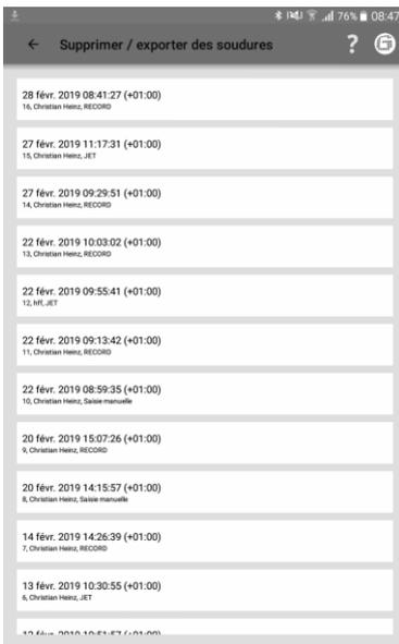
1. Dans le menu, appuyez sur **WELDS** pour afficher tous les processus de préchauffage et de soudage enregistrés dans une liste.
