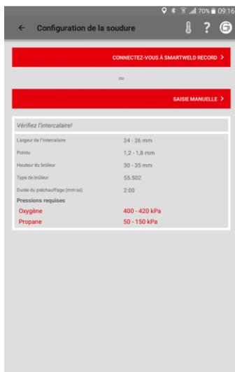
1. Vérifiez les paramètres de soudage saisis et respectez les spécifications de pression recommandées.
