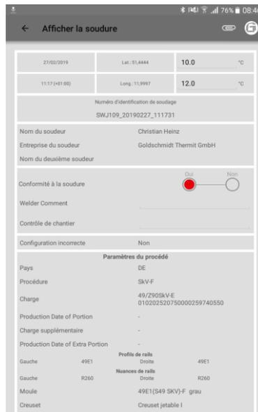
Il est possible de visualiser les détails des processus de préchauffage et de soudage et de modifier partiellement les détails. Un point d'exclamation rouge indique des paramètres non valides.
