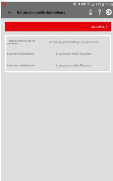
1. Entrez manuellement le temps de préchauffage et les pressions de gaz dans les champs d'entrée.
