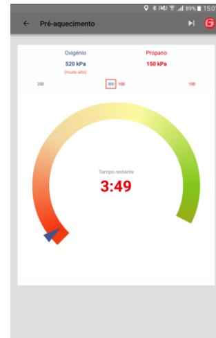
O diagrama mostra os tempos restantes de pré-aquecimento. Durante o pré-aquecimento, o aplicativo SMARTWELD registra a pressão de ambos os gases a cada segundo. Se a pressão de fluxo de um gás durante o pré-aquecimento mudar muito, o usuário é avisado por uma vibração do smartphone/tablet e marcações vermelhas no respectivo valor limite.
