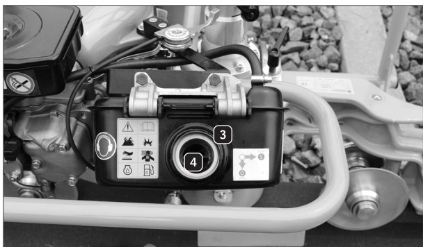
Abbildung 27: GP 4000 D – Diesel auffüllen 2
