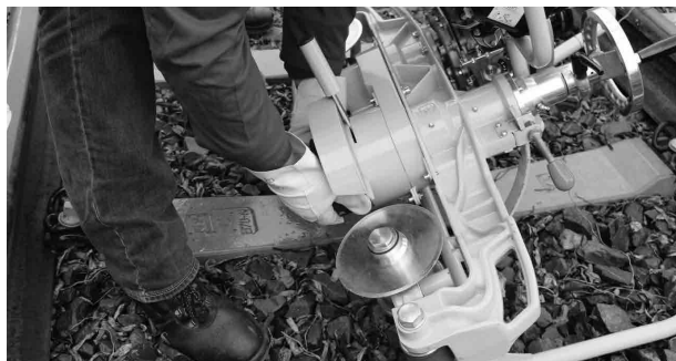
Illustration 24 : remplacement de la meule
