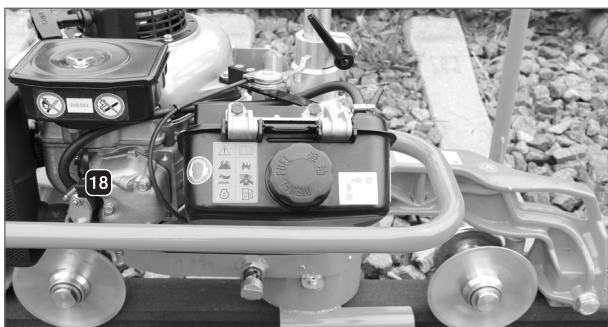
Abbildung 22: Öleinfüllverschluss für den Kaltstart
