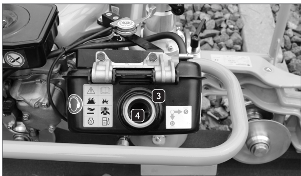
Illustration 27 : GP 4000 D – Faire le plein de gasoil 2
