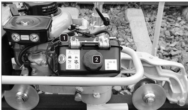
Abbildung 26: GP 4000 D – Diesel auffüllen 1
