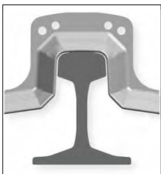
Afb. 2-2 Schuifschoentyp A - Vignolrails
