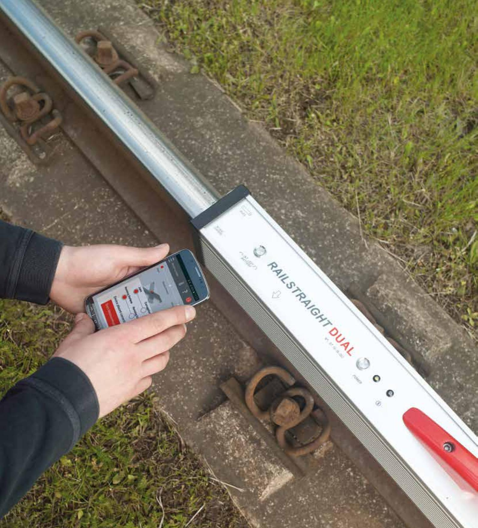
En tant que partenaire compétent, nous proposons une vaste gamme de prestations en métrologie. À commencer par les instruments conçus pour le contrôle des rails : du profilé longitudinal à la géométrie et au positionnement des voies en passant par l'analyse de la qualité de la finition.
