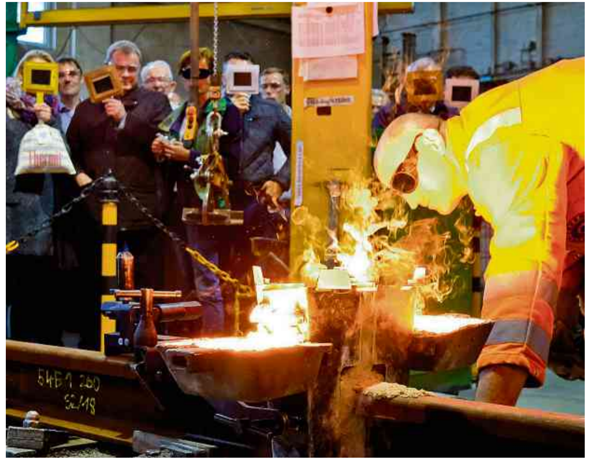
Bei einer Werksführung konnten sich die Gäste das Thermit-Schweißen live anschauen.
