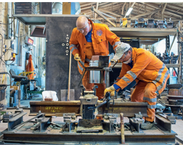
Qualitätskontrolle: Testschweißung in der hauseigenen Schweißwerkstatt
