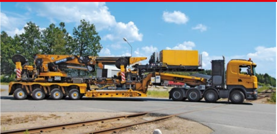
KRT 65, weltweit größter selbstfahrender Zweiwegehänger
