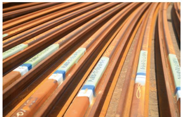
*Stark beanspruchten Gleisanlagen droht schon nach kurzer Zeit hoher Verschleiß – unsere werksseitig vergüteten Schienen sind darauf bestens vorbereitet und halten entsprechend länger.*
