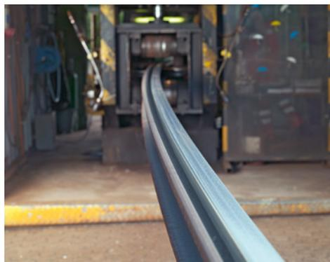
*Vergütete Schienen werden in Längen von 15 bzw. 18 m hergestellt.*
