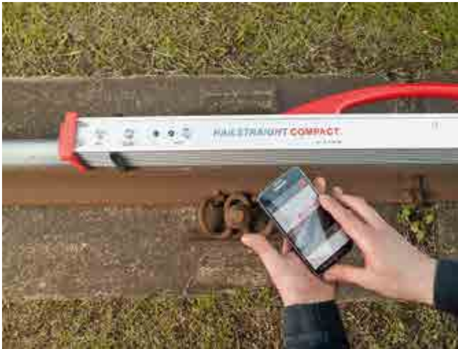
Bild 8: Digitale Messlineale und Auswertung per App
