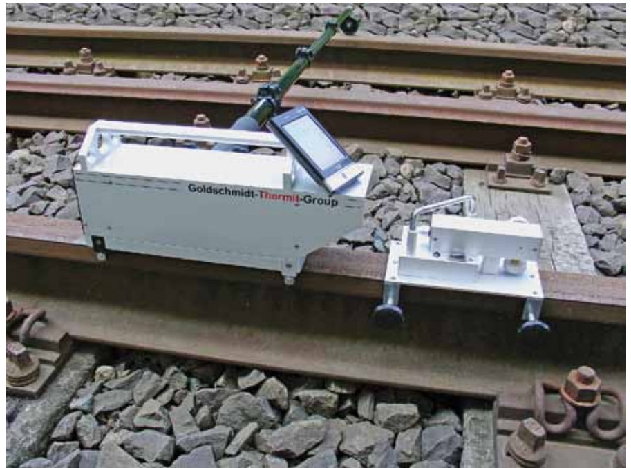
Bild 3: Railstraight Laser mit Handrechner
