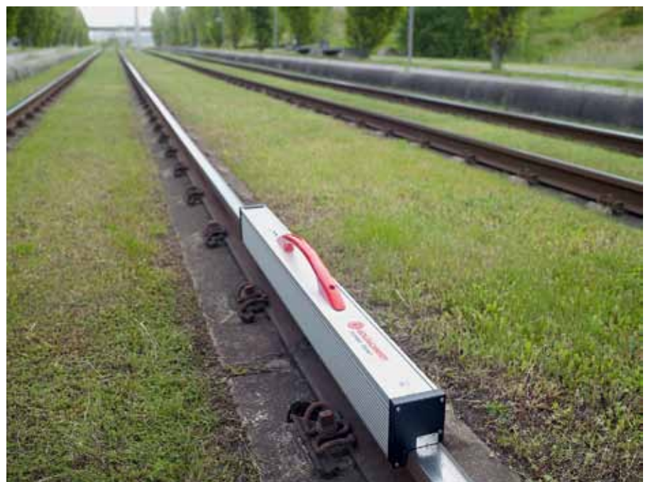
■ Bild 2: Das Railstraight Dual für die synchrone Messung von Fahrfläche und Fahrkante
