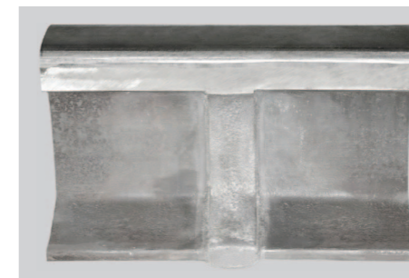
Fertige SoW-5 - Schweißung Finished SoW-5 Weld Soudure terminée avec SoW-5
