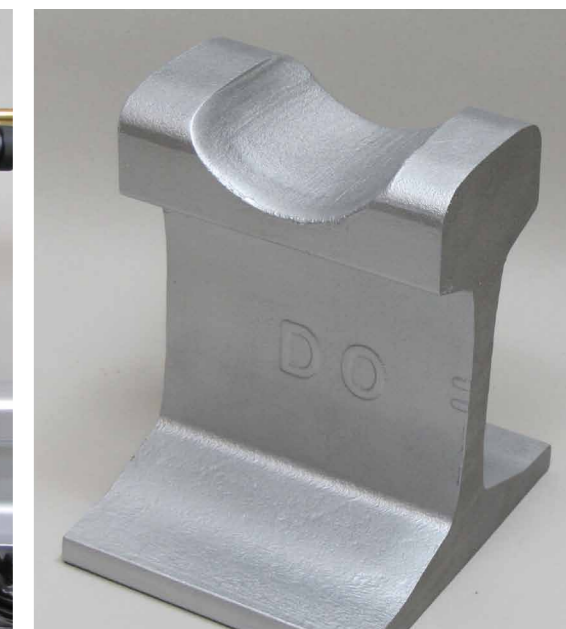
Fuge im Schienenkopf zur Herstellung einer THR-Schweißung Excavation in the rail head to produce a THR weld Joint sur la tête de champignon pour la soudure THR
